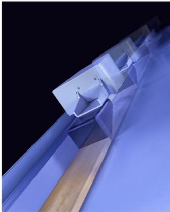
Поворотный позиционирующий толкатель для высокой производительности благодаря непрерывной подаче с пневматическим выравниванием во время поднимания и опускания.
